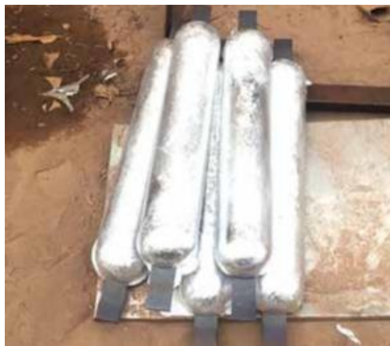
Hình 5. Anode hy sinh hợp kim kẽm sau khi đúc
