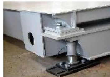
Hình 1.8: Vị trí lắp đặt loadcell
