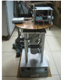
Hình 4. Động cơ servo có điều khiển tạo vận tốc góc.
