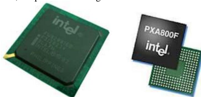
Chipset Sourth Bridge là IC chân gằm
