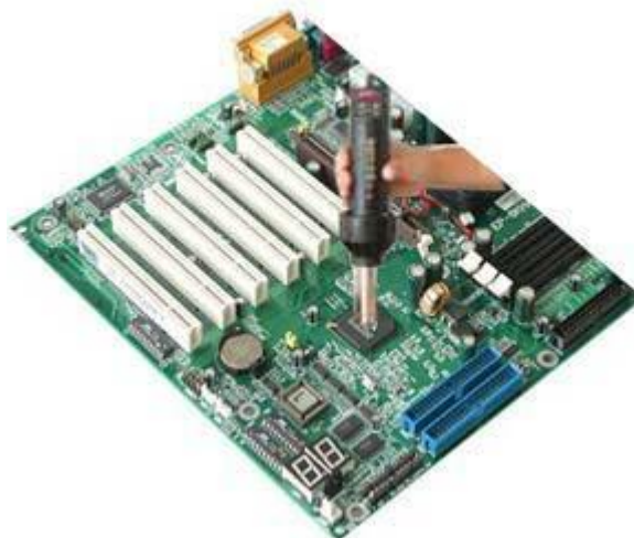
Khò lại chipset nam bằng máy hàn khô
